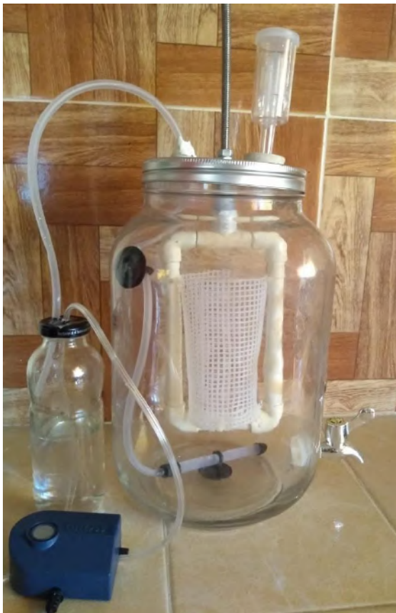
Figura 1. Biorreactor aerobio usado en la elaboración
